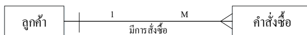
ภาพที่ 2.11 แสดงความสัมพันธ์แบบ One To Many Relationships
