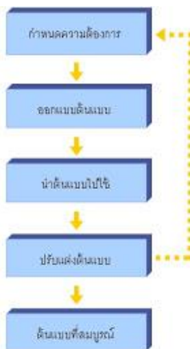
ภาพที่ 2.2 ขั้นตอนการสร้างต้นแบบ (Prototyping Process)
