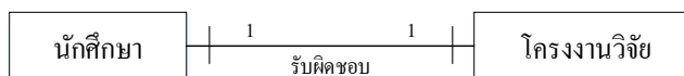
ภาพที่ 2.10 แสดงความสัมพันธ์แบบ One To One Relationships
